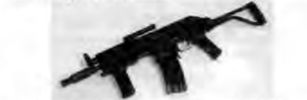
Mini Beryl z adapterem do magazynków M16. Jest on mocowany w gnieździe dokładnie na takiej samej zasadzie, jak wpina się w nie standardowy magazynek Beryla – przy wykorzystaniu zaczepu na przedniej ścianie i zęba do przyłączania na tylniej
