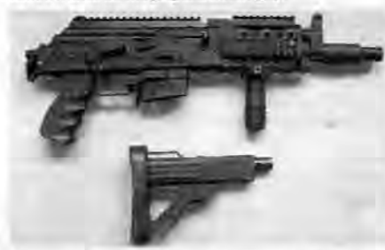
Beryl pozbawiony mechanicznych przyrządów celowniczych zamocowaną na zawieszki pokrywki komory zamkowej ze zintegrowaną szyną, z magazynkiem C-Mag i składaną na prawo kolbą z nową poduszką policzkową
